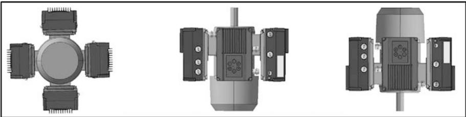
Abb.: 9 Motoreinbaulage / Zulässige Ausrichtung
