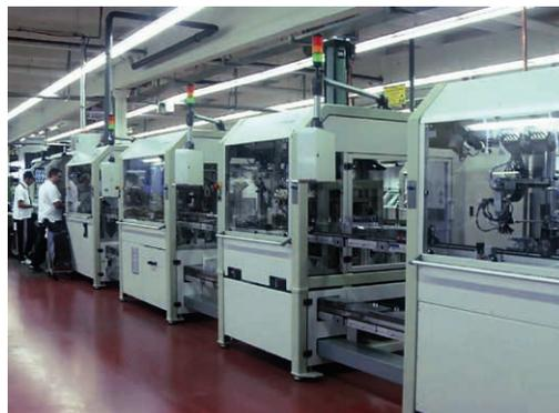
Hochautomatisierte Produktionslinie der PV-Modul-Anschlussdosen
